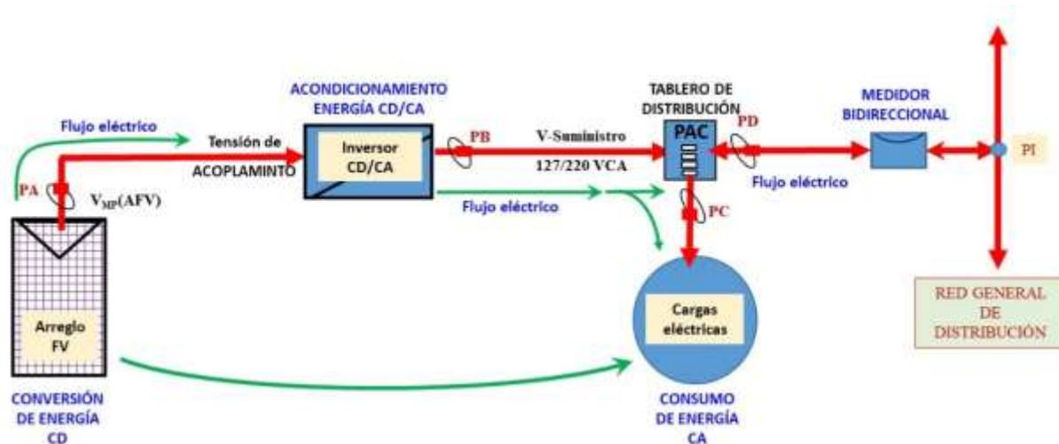
**Figura 4:** Diagrama esquemático de la arquitectura típica de un sistema FV-I. Se indican los puntos de medición en el diagrama en donde se recomienda colocar los sensores para el monitoreo energético.
