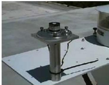
FOTODIODO DE SILICIO
